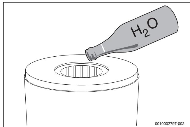
Fig. 48 Clătirea blocului de căldură cu apă
