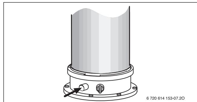
Fig. 35 Orificiu de măsurare a gazelor arse
