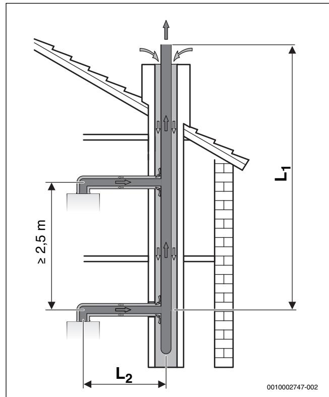
Fig. 18 Alocare multiplă cu țeavă concentrică în conformitate cu C<sub>43</sub>
