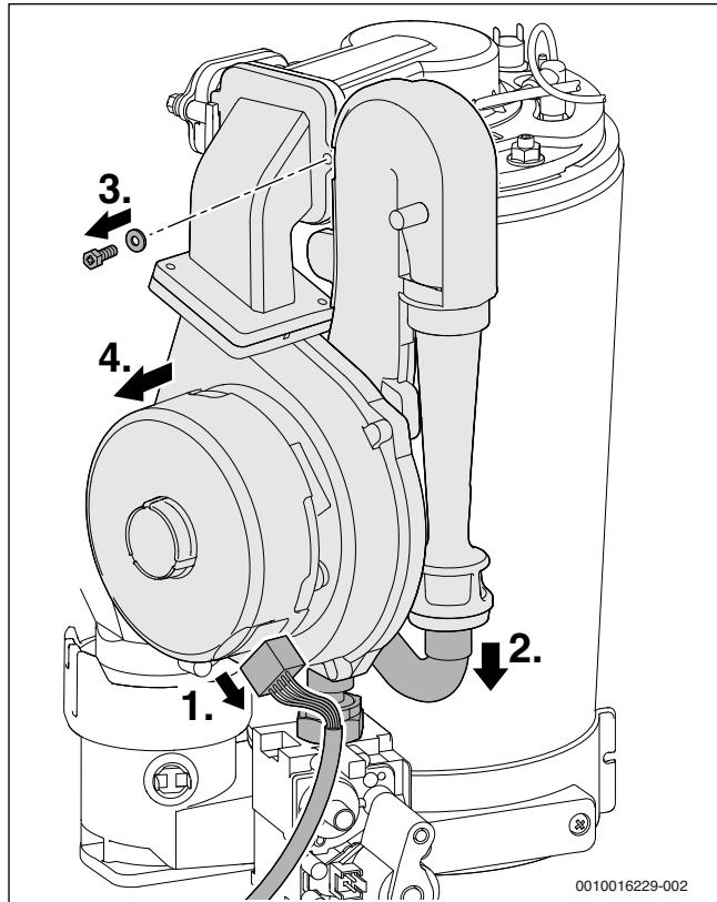
Fig. 40 Demontarea suflantei și a dispozitivului de amestecare
