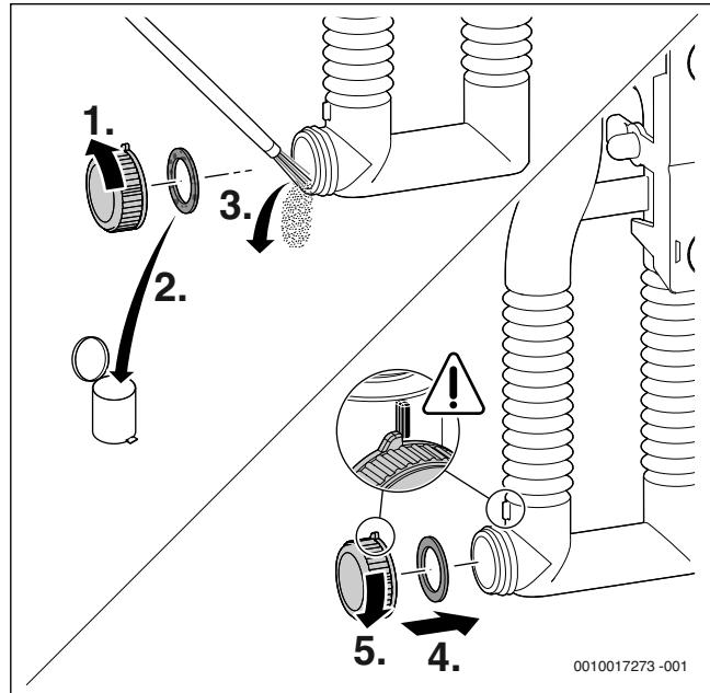
Fig. 50 Curățarea sifonului pentru condensat
