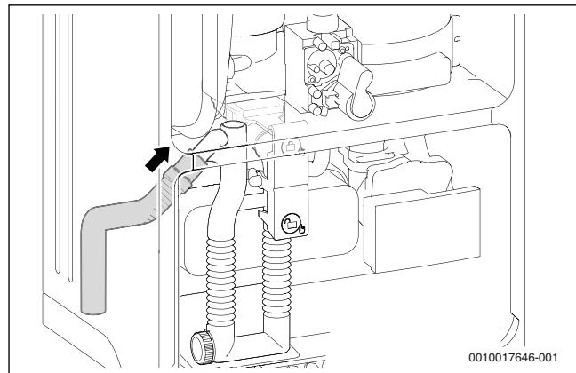
Fig. 25 Montarea furtunului la sifonul pentru condensat
