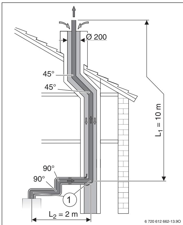
Fig. 17 Situație de montare pentru ghidarea gazelor arse în puț conform C<sub>93</sub>
