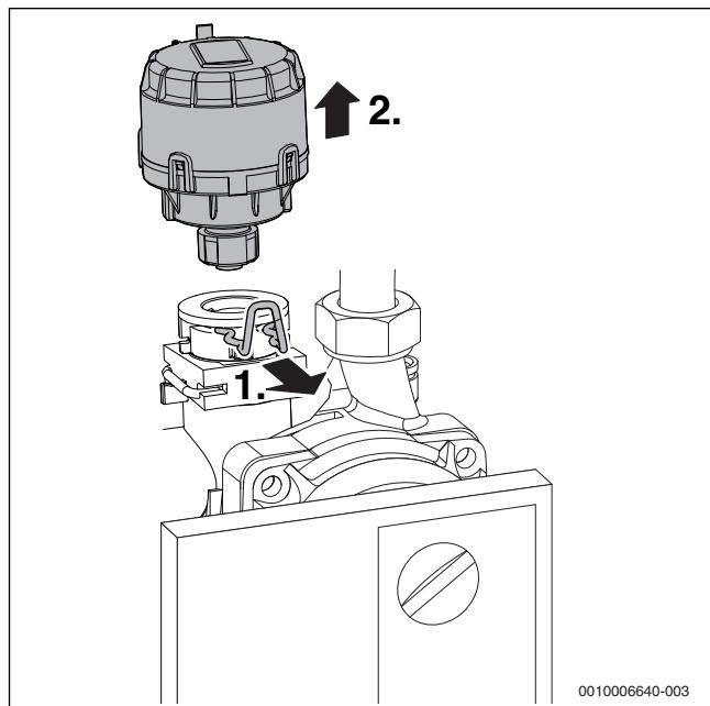
Fig. 62 Demontarea motorului vanei cu 3 căi
