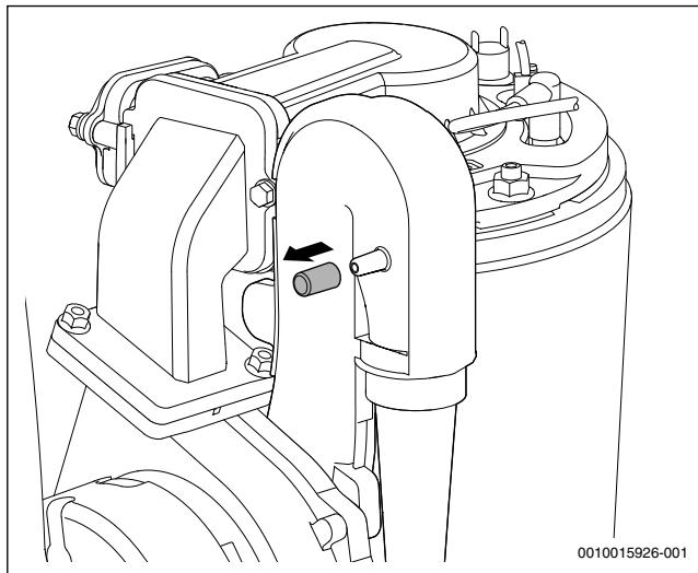
Fig. 39 Orificiu de măsurare la sistemul de amestecare
