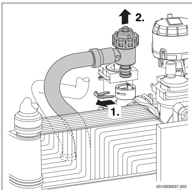
Fig. 55 Scoaterea supapei de siguranță (circuit de încălzire)
