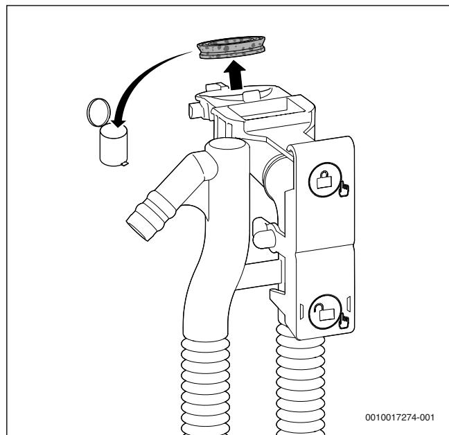
Fig. 51 Înlocuirea garniturii de etanșare de pe partea superioară a sifonului pentru condensat
