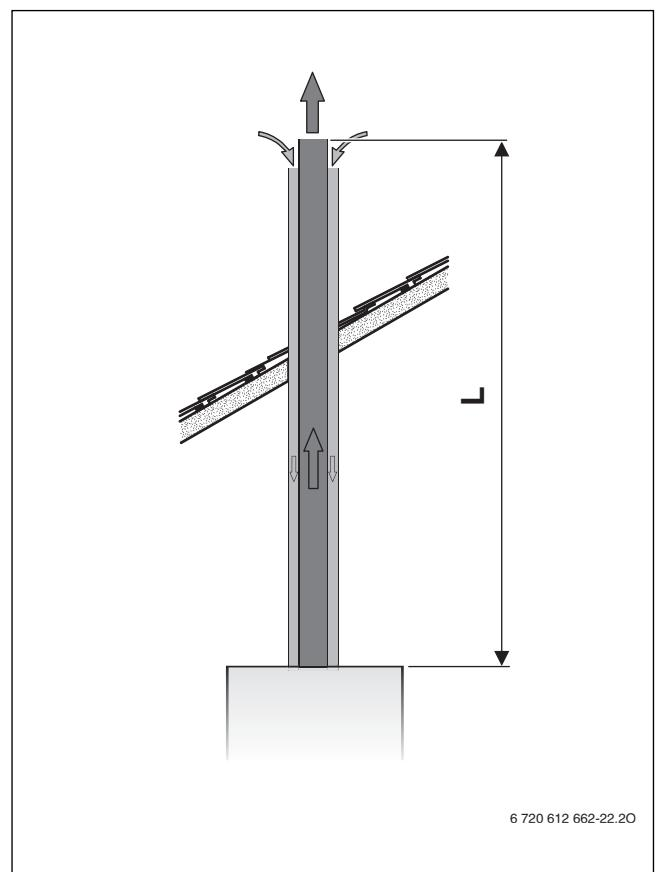
Fig. 14 Ghidarea gazelor arse pe verticală conform C<sub>33</sub>
