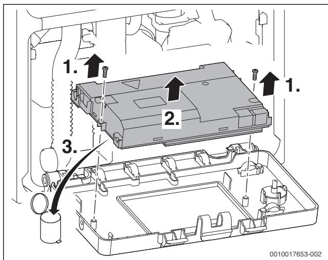
Fig. 65 Îndepărtarea capacului și înlocuirea plăcii electronice
