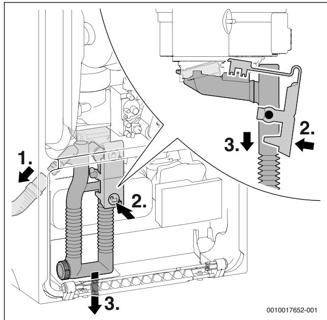
Fig. 49 Demontarea sifonului pentru condensat
