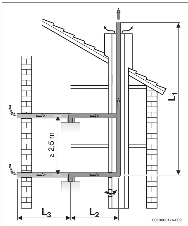
Fig. 19 Alocare multiplă cu țeavă izolată C<sub>83</sub>
