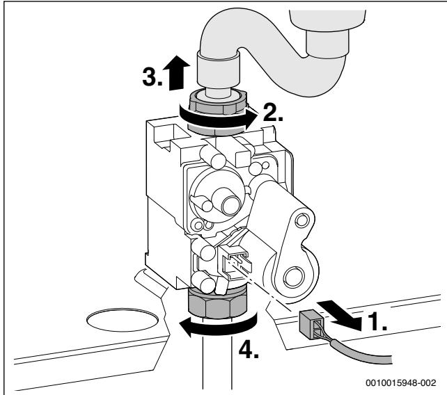
Fig. 58 Scoaterea ștecherului și desfacerea piulițelor oarbe
