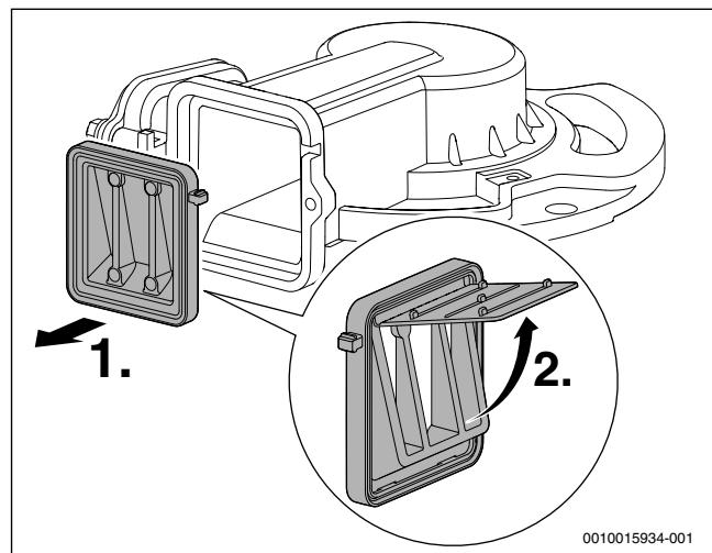
Fig. 42 Clapeta de sens din sistemul de amestecare
