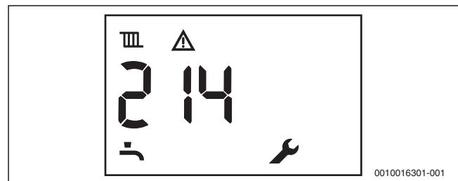
Fig. 68 Exemplu: defectiune care nu determină blocare
