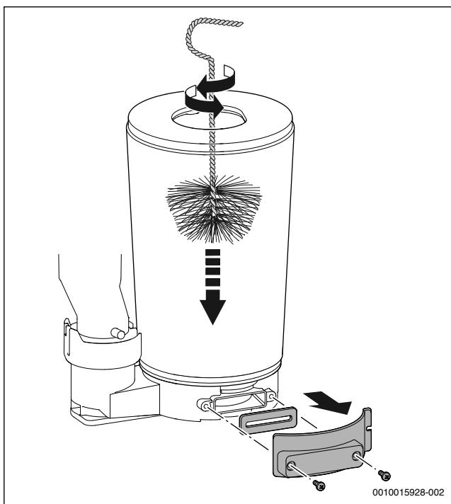
Fig. 46 Curățarea blocului de căldură
