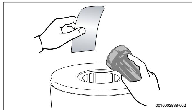
Fig. 47 Verificarea blocului de căldură în privința reziduurilor
