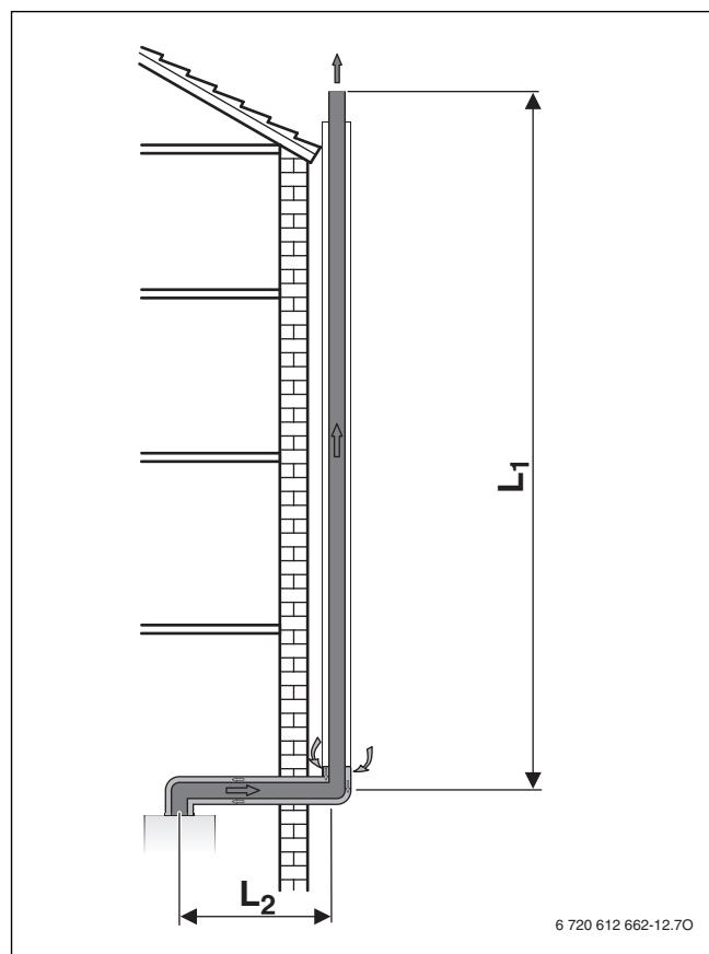
Fig. 16 Ghidarea gazelor arse la fațadă conform C<sub>53</sub>
