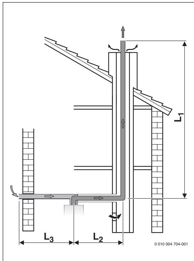
Fig. 10 Ghidarea gazelor arse în puț conform C<sub>53</sub>
