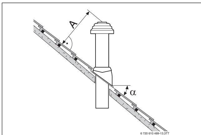
Fig. 6 Distanțe și pante la acoperișul oblic
