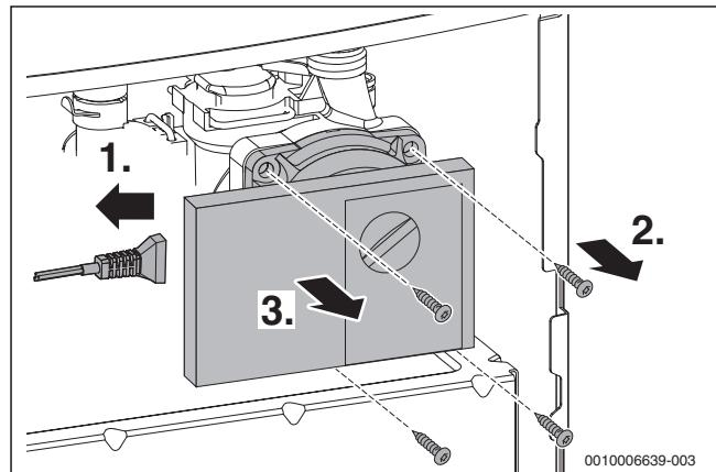
Fig. 60 Demontarea pompei pentru circuitul de încălzire
