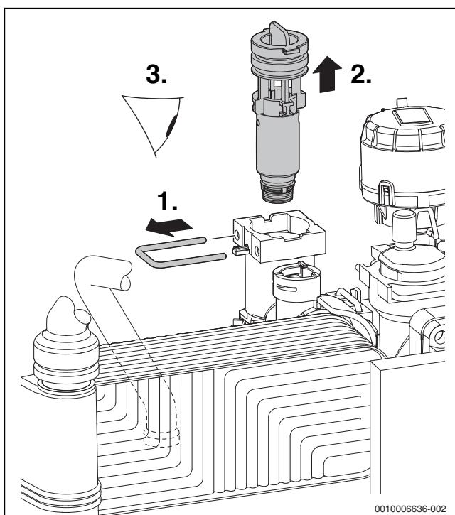
Fig. 56 Verificarea sitei din țeava pentru apă rece
