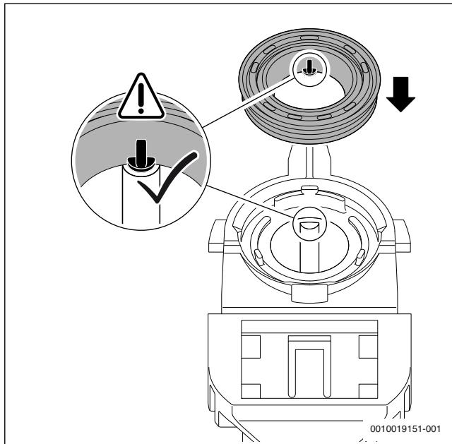
Fig. 52 Ajustarea garniturii noi pe sifonul pentru condensat
