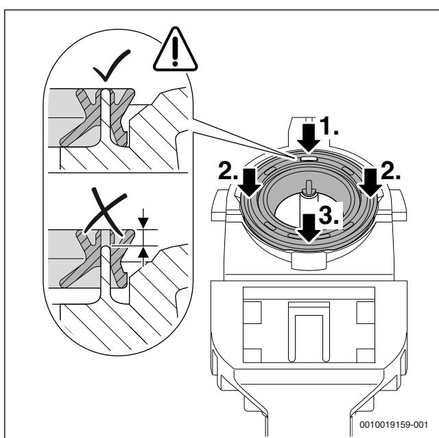
Fig. 53 Fixarea prin apăsare a garniturii de etanșare
