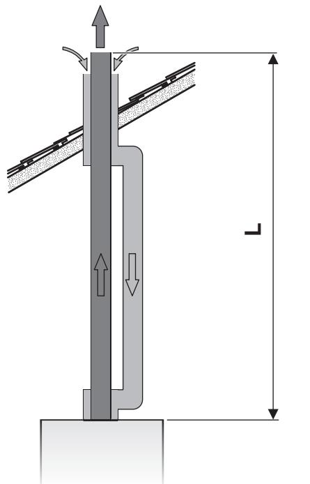
Fig. 15 Ghidarea gazelor arse pe verticală conform C<sub>33</sub>
