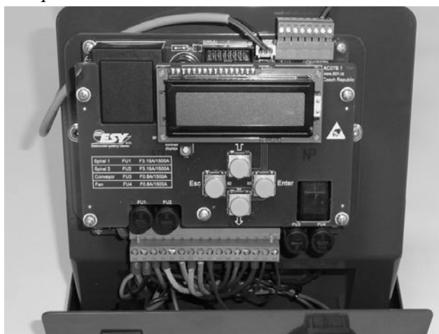
Fig. 5 – unitate electronică de comandă cu butoane, cutia de borne inferioară (1-18), cutia de borne superioară pentru conectarea senzorilor TS (poziția 3 și 4) și TV (poziția 6 și 7)
