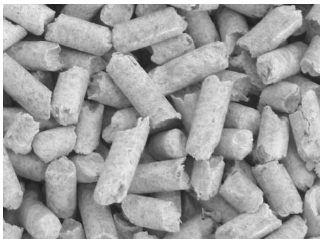
Fig. 17 – pelete de lemn de calitate superioară – alb fără puncte negre (coajă)
