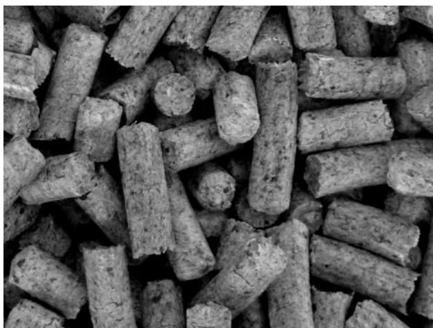
Fig. 18 – pelete de lemn de calitate inferioară – de culoare închisă, cu coajă (cu puncte negre)
