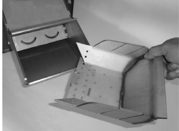
Fig. 2 – Camera de ardere demontabilă – trebuie curățată în mod regulat
